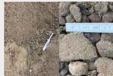
Bild 2 Material aus dem Schaufelseparator in der Leitungszone (l.); Überschotter in der Leitungszone (r.).
